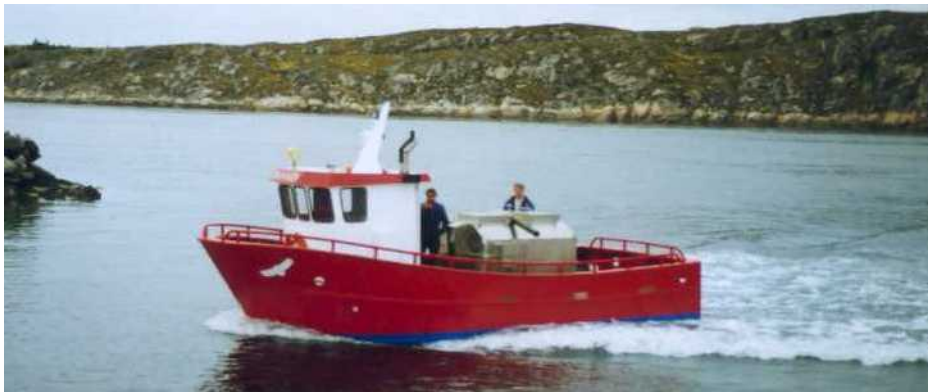
Bilde 1 Lukket foringsbåt for matfisk, ca. 30 fot, aluminium (foto: Halvard Aasjord)
