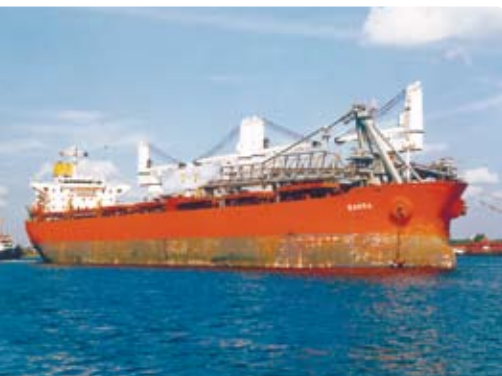
Bulkskipet Bakra er utstyrt med eget losseutstyr.
