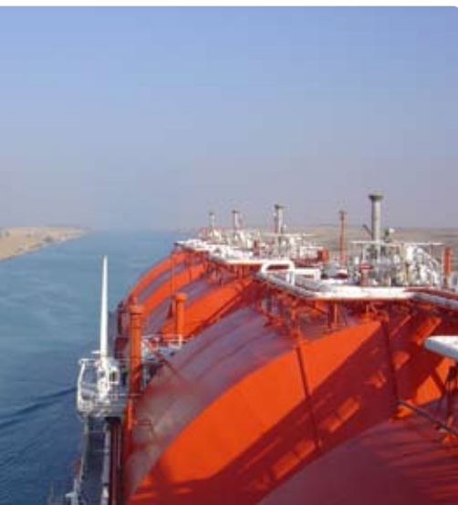
Naturgass som fraktes nedkjølt i flytende form (Liquefied Natural Gas=LNG) er blitt en viktig energikilde Foto Höegh LNG
