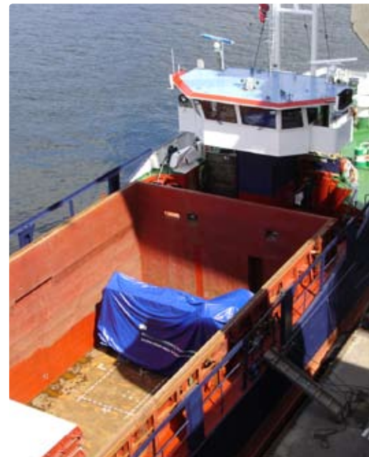
På moderne skip kan lasterommene åpnes i full lengde og bredde.
